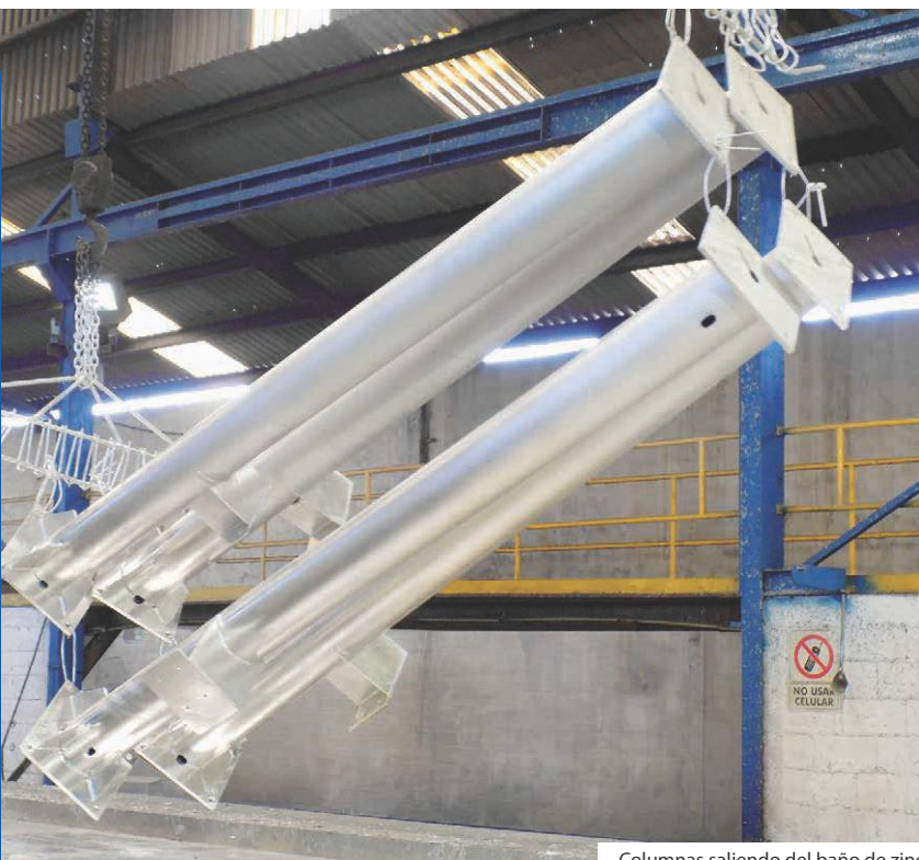
Columnas saliendo del baño de zinc
